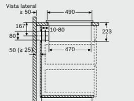
Al realizar la instalación directamente en paredes exteriores no aisladas ( $\mu \geq 0,5 \text{ W/m}^2 \text{ °C}$ ), recomendamos el uso de configuraciones de recirculación total o parcialmente canalizada.
